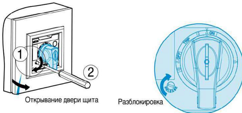
а) Блокировка дверцы щита TD/TS100-800
