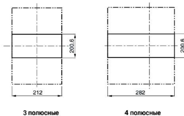
Рисунок Б.16 – Габаритные и монтажные размеры выводов для подключения сзади
