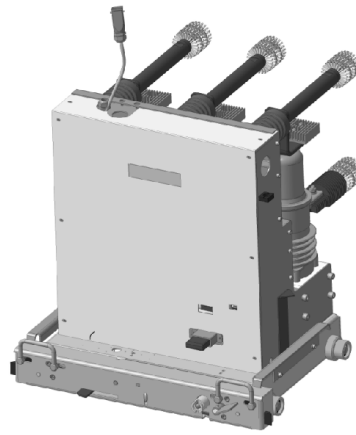
Рисунок 28 - Выдвижной элемент с вакуумным выключателем ВВ/TEL-10-20/1000У2
