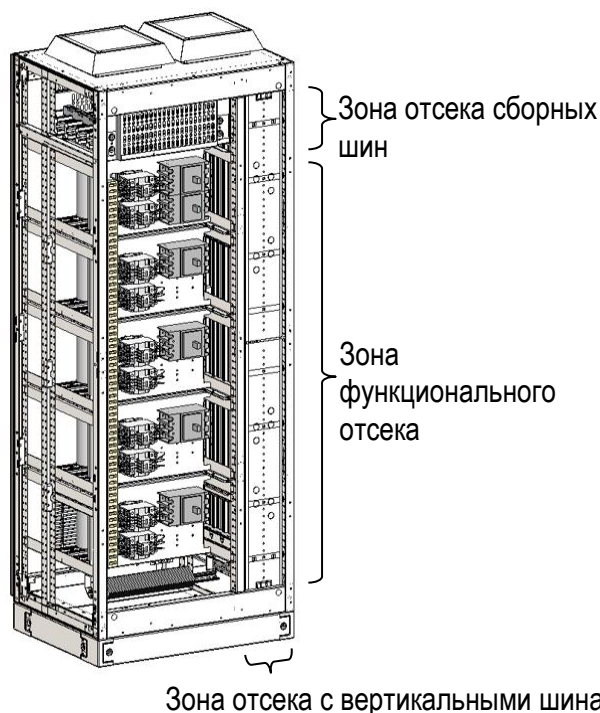
Рисунок 11 - Шкаф с устройствами компенсации реактивной мощности
